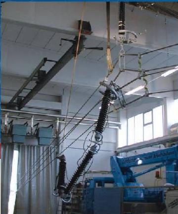
Badanie obciążenia mechanicznego łańcucha
