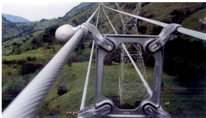
Odstępnik firmy DAMP na linii 500 kV w Kolumbii
