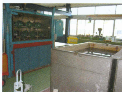
Zdj. 11: Test wytrzymałości resztkowej po cyklach termicznych na 30 letnich izolatorach HVDC
