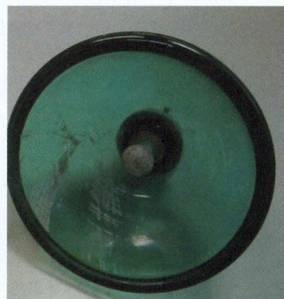
Izolator szklany, nr ref. N14R2 po 30 latach eksploatacji w USA
