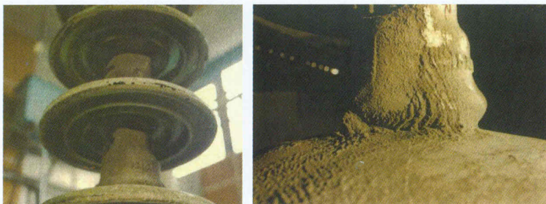
Izolator szklany, nr ref. BS1513, po 27 latach eksploatacji w Malezji
