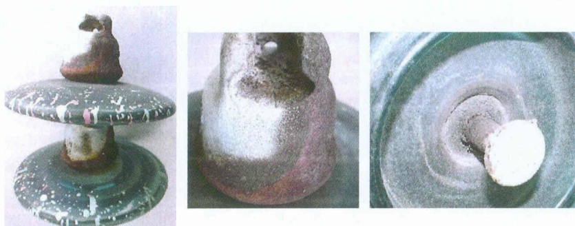
Izolator szklany, nr ref. 1502, po 40 latach eksploatacji w Holandii
