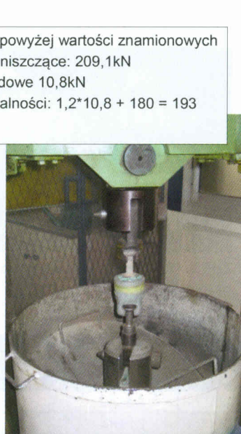
Zdj. 11: Test wytrzymałości resztkowej po cyklach termicznych na 30 letnich izolatorach HVDC
